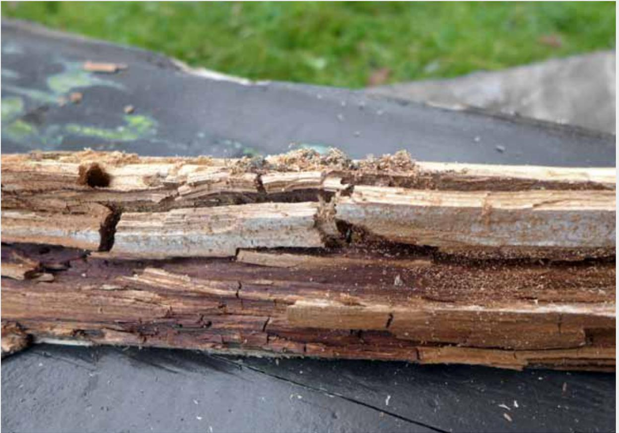
Verwittertes Holz aus dem Inneren eines Tragbalkens
