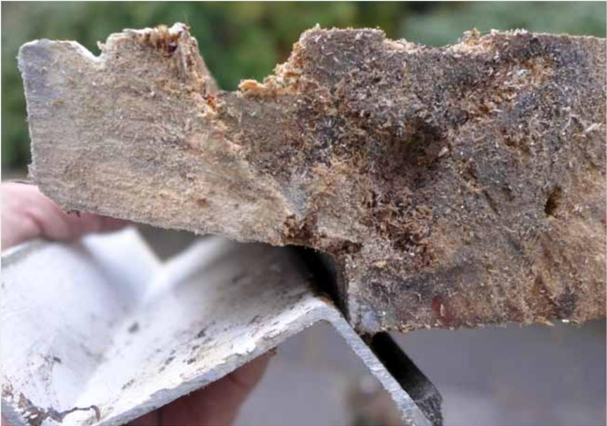
Fäulnis durch Kondensat an der Nut zur Auflage auf die äußeren Fassadenplatten
