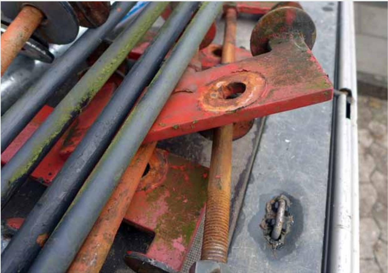
Die ausgebauten Stahlteile werden in einer Schlosserei gereinigt und wieder funktionstüchtig gemacht
